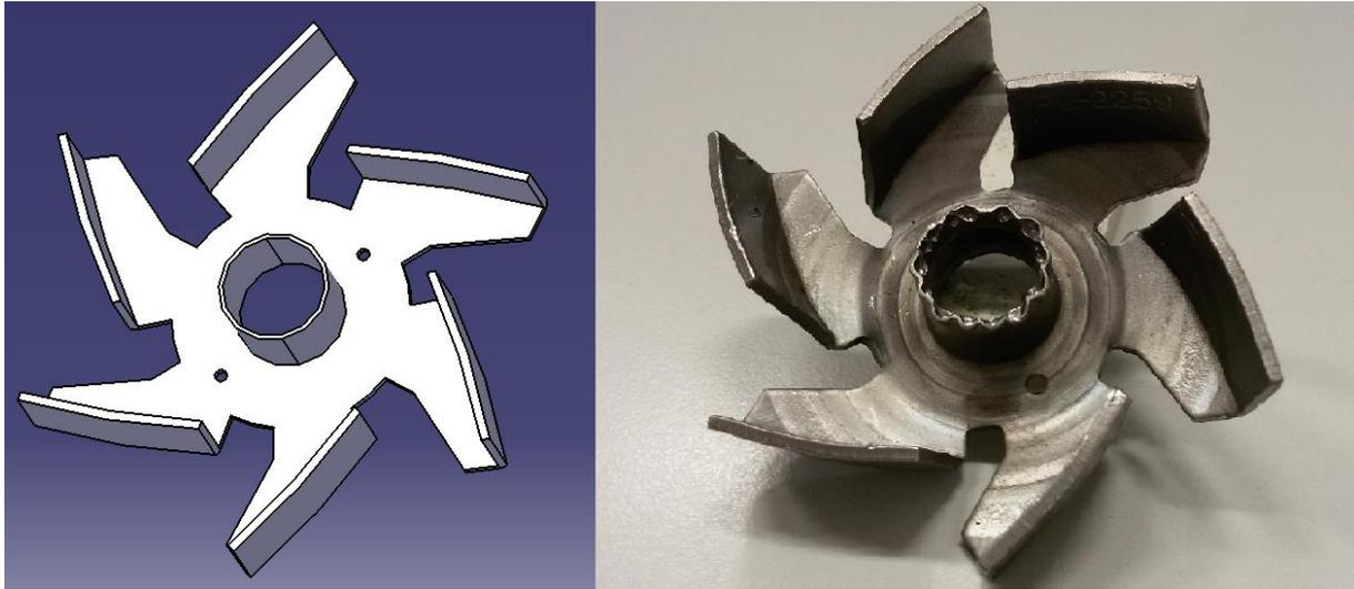
Abbildung 5: Laufrad CAD und real
