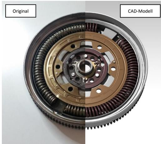
Zu Simulationszwecken wurde das ZMS zerlegt, vermessen und nachmodelliert. Es entstand eine virtuelle Baugruppe, die 15 einzelne Bauteile umfasst.
